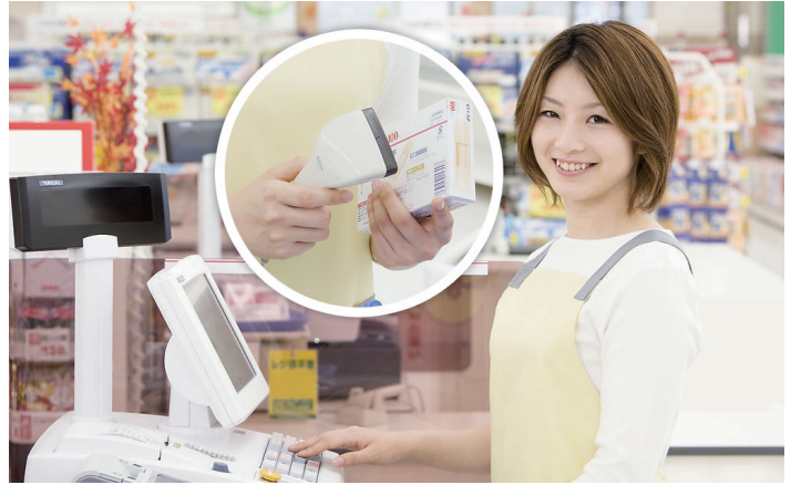
►圖1-14 利用POS系統可以進行收銀與銷售的作業，還具有銷售記錄、庫存管理、結合收銀機、條碼掃描，以及發票或收據開立等功能。
